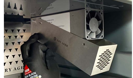
6. Ziehen Sie die Abdeckung aus der hinteren Halterung heraus.
